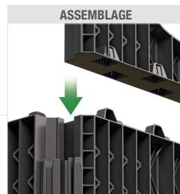
Proseguire con lo stesso metodo di incastro con gli altri componenti verticali fino a chiudere i moduli Rootbox, che sono ora autoportanti. Continuare alla stessa maniera per proseguire con l'installazione del primo livello di Rootbox. In questa fase si può iniziare l'installazione gli impianti di irrigazione, aerazione o altro.
