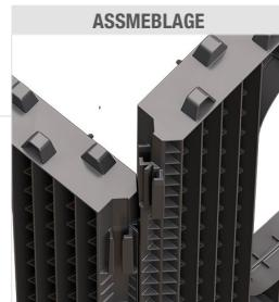
La struttura verticale di Rootbox si compone di un solo elemento verticale universale che compone le pareti del sistema. Facendo scorrere il perno maschio nell'alloggiamento femmina della parete da collegare, gli speciali agganci a slitta permettono un accoppiamento semplice e solido.
