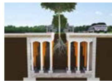
Sección sistema Nuevo Elevetor
