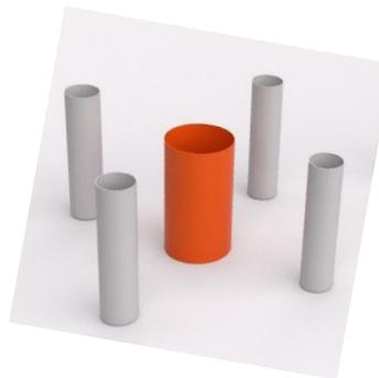
Sistema di tubi di sostegno e per la realizzazione delle colonne di supporto ad altezza variabile. I tubi con diametro 125 mm serviranno da puntelli a perdere per il sostegno dei casseri durante la fase di montaggio. I tubi di diametro 250 o 300 mm fungeranno da sostegno ma anche da cassaforma per il pilastro strutturale del sistema
