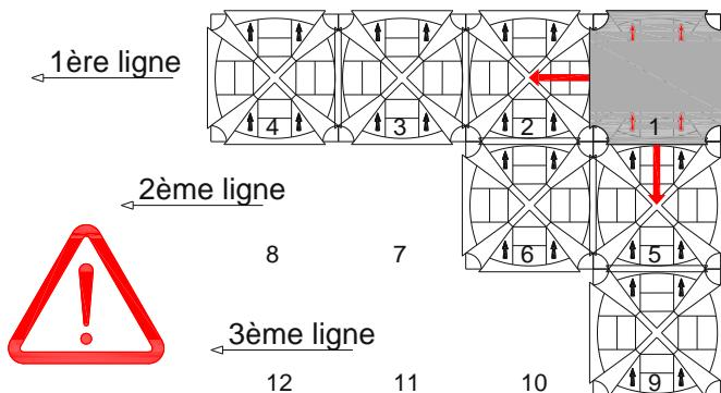
Avant de commencer l'installation des éléments, svp de consulter les plans de calepinage du projet produits par Geoplast® afin de positionner les éléments correctement. Pour une installation correcte et conforme aux consignes de sécurité, veuillez SVP vous référer au manuel d'installation.
