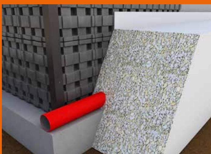
Vor der Einreichung der natürlichen Gelände, gießen Sie den Kies in der Nähe der Abflussrohr und dann verlegen Sie das Geotextil darauf.
