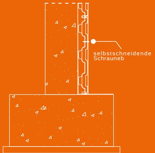
Anbringung eines Streifens Plastikkartons neben den Ecken und Befestigung des Streifens mit DEFENDER mittels selbstschneidender Schrauben am höchstens 50mm lang.
